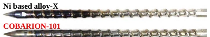
Fig.6 PFA成形後のスクリュー外観 (総shot数 30,000)
